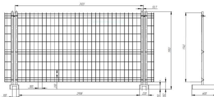
Панель изготовлена из стальных оцинкованных прутков толщиной 3,5 мм, защищённых методом горячего цинкования. Столбы временного ограждения профилируются из холоднокатаной горячеоцинкованной стали.
