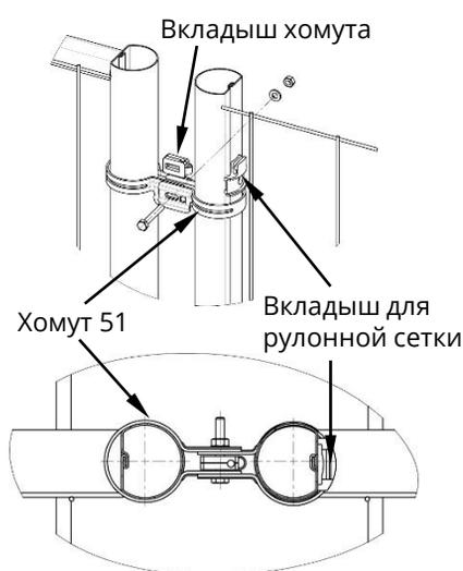
В качестве петли выступает крепление Хомут 51 с пластиковым вкладышем для рулонной сетки.
