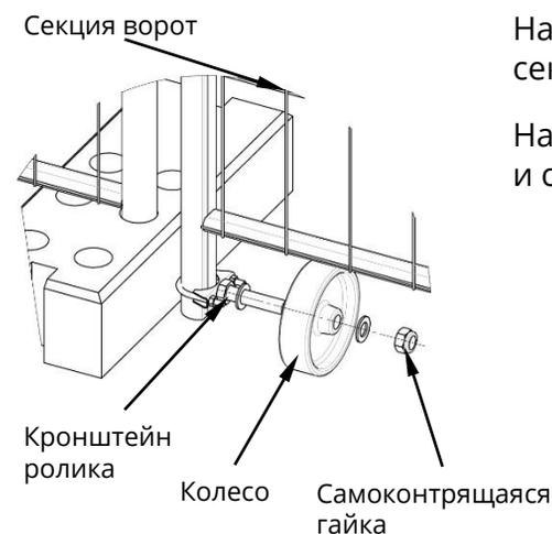
На нижнюю часть столба с противоположной стороны секции ворот смонтируйте кронштейн для ролика.
